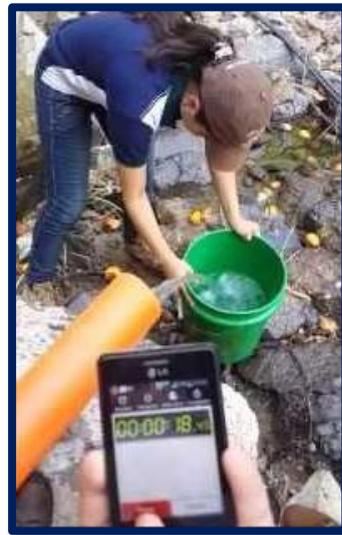
**Figura 7** Medición del caudal (método volumétrico)
