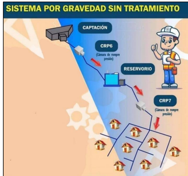
Figura 3: Sistema de agua potable por gravedad.
