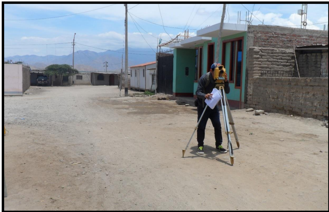
Imagen 10. Levantamiento topográfico del caserío de Virahuanca con el uso de teodolito
