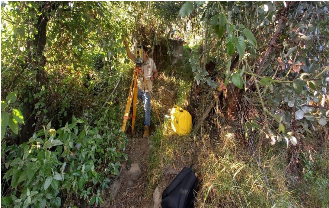
Imagen 19. Tomando coordenadas de las viviendas del caserío de Huarascucho
