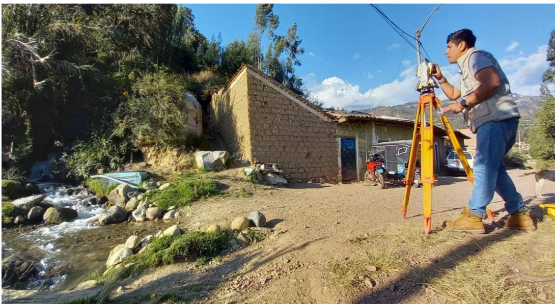
Imagen 17. Tomando coordenadas de las viviendas del caserío de Huarascucho
