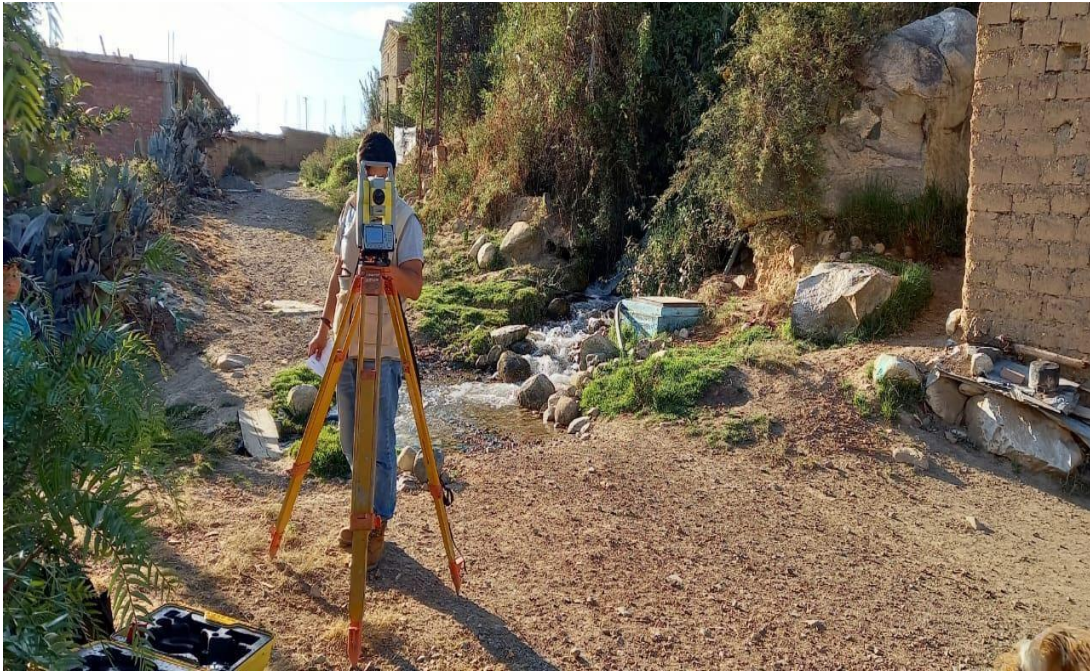
Imagen 18. Tomando coordenadas de las viviendas del caserío de Huarascucho
