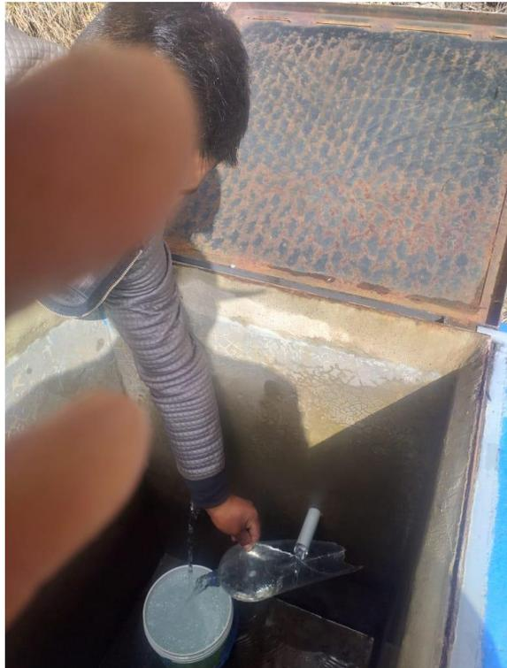
**Fotografía 4. Aforamiento del caudal de la captación**
