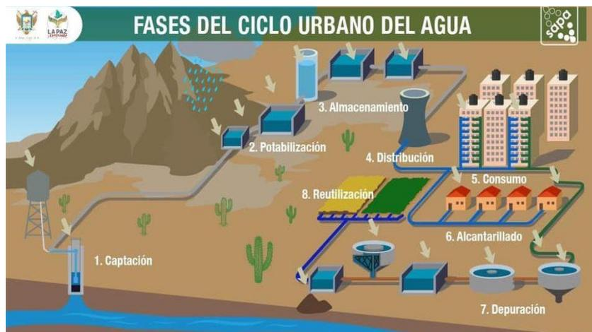
Gráfico 1. Esquema de sistema de Agua Potable
