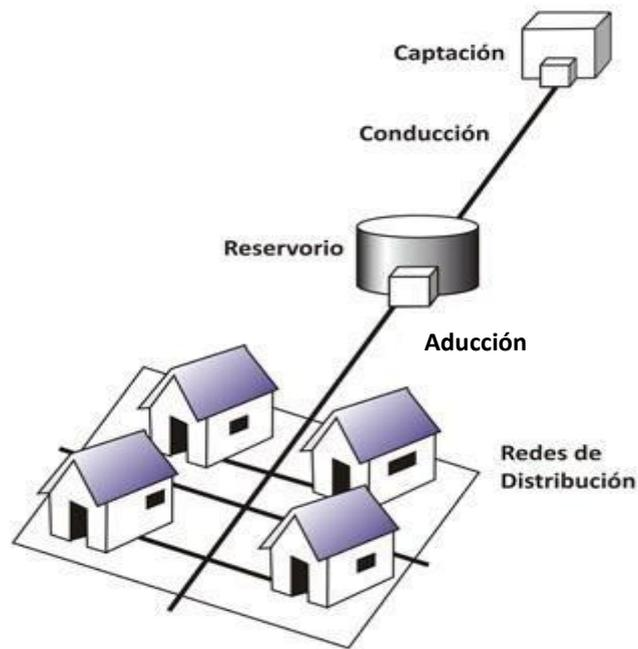
**Imagen 1** : partes elementales del Sistema de abastecimiento de agua potable rudimentario.
