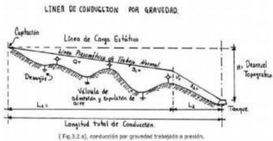
**Imagen 6 :** línea de conducción por gravedad.
