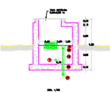
CAPTACIÓN DE LADERA: CORTE B-B Escala 1/20
