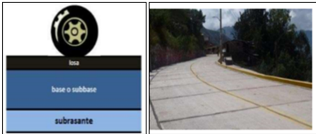
Figura 2.2: Estructura de un pavimento rígido. Fuente:(Ramos, (2013)).
