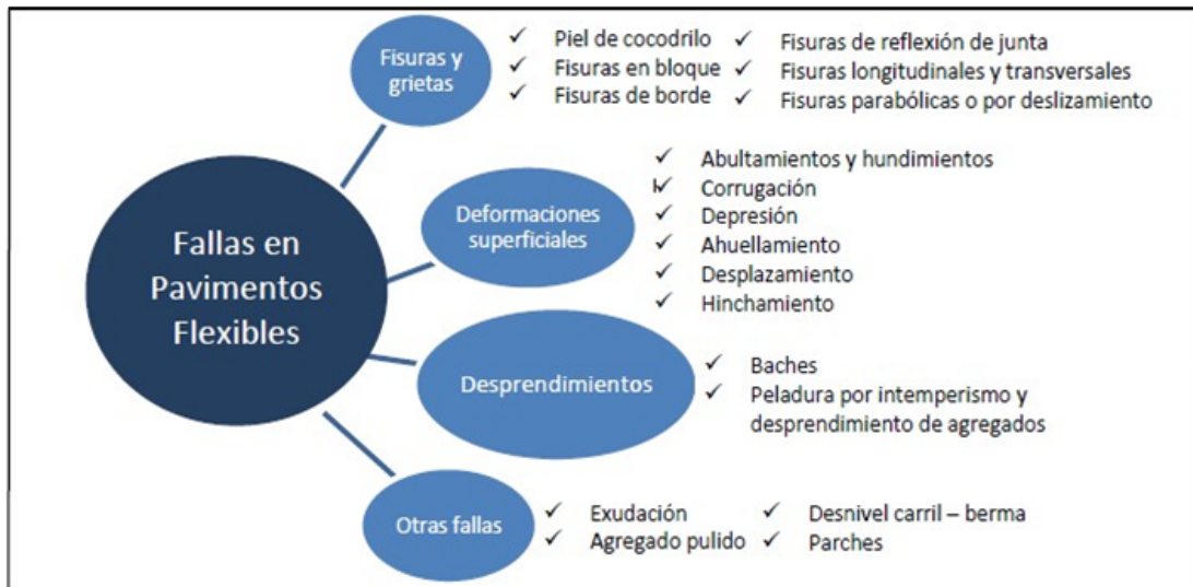
Figura 2.5: Fallas en Pavimentos Flexibles. Fuente:(Cálculo del Índice de Condición del Pavimento (PCI)).
