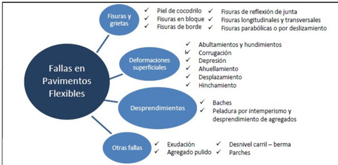
Figura 2.5: Fallas en Pavimentos Flexibles.
