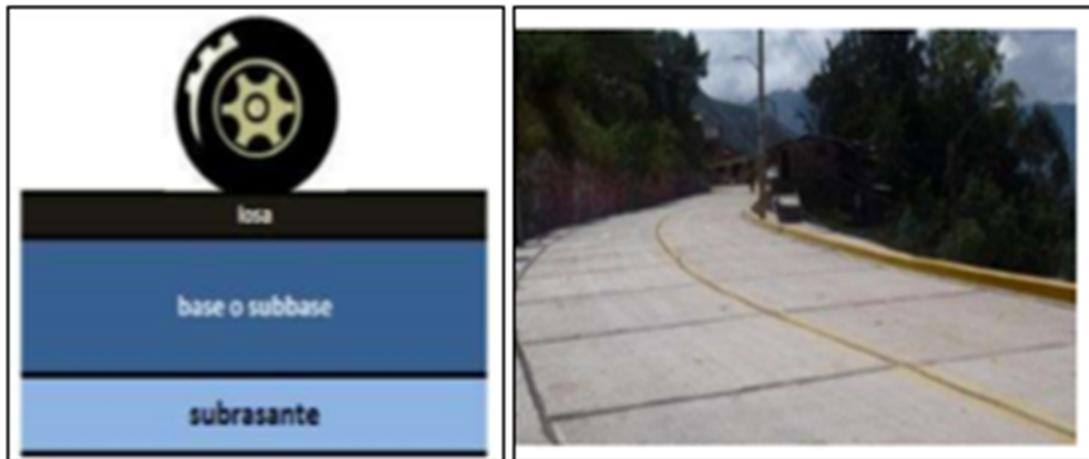
Figura 2.2: Estructura de un pavimento rígido.
