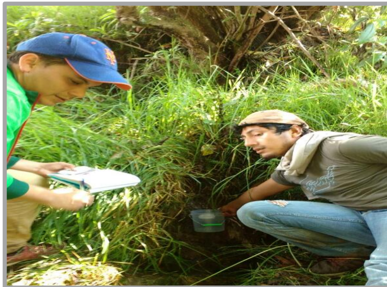
Figura 6: Aforo de agua por método volumétrico
