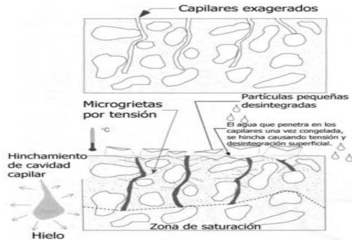
Imagen 22: Esquema de deterioro causado por ciclos de hielo y deshielo
