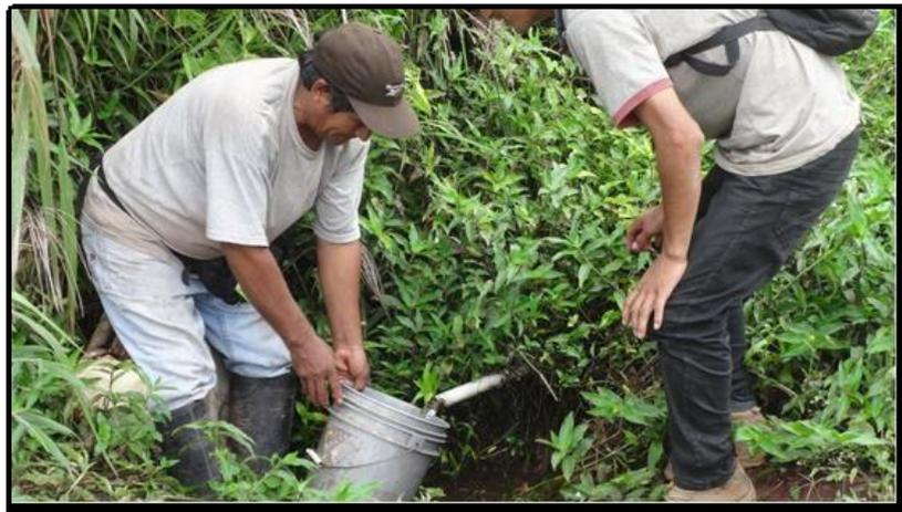
**Figura 17:** Aforamiento de la nueva fuente donde se proyectará la captación
