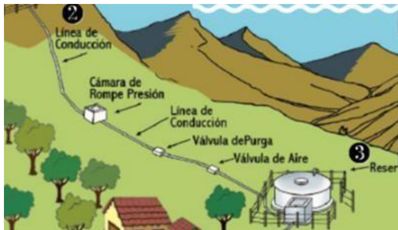
Grafico 12. Línea de conducción Fuente: Sanitary Engineer – 2020.
