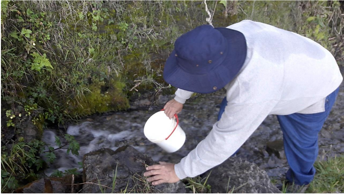
Ilustración 2. Realizando el cálculo volumétrico
