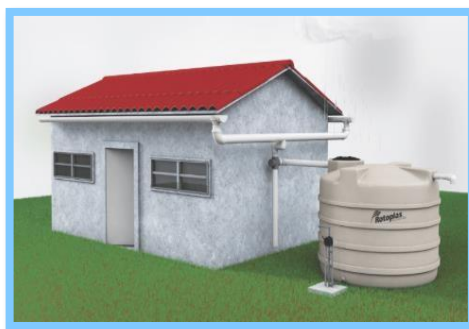
Figura 4. Captación de agua pluvial.
