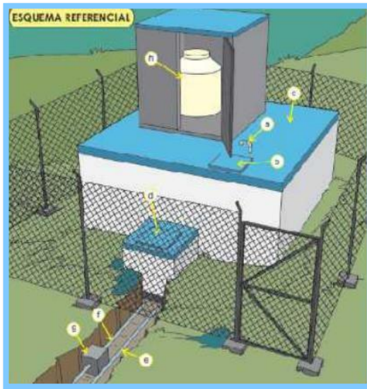
Figura 14. Esquema de un reservorio apoyado.
