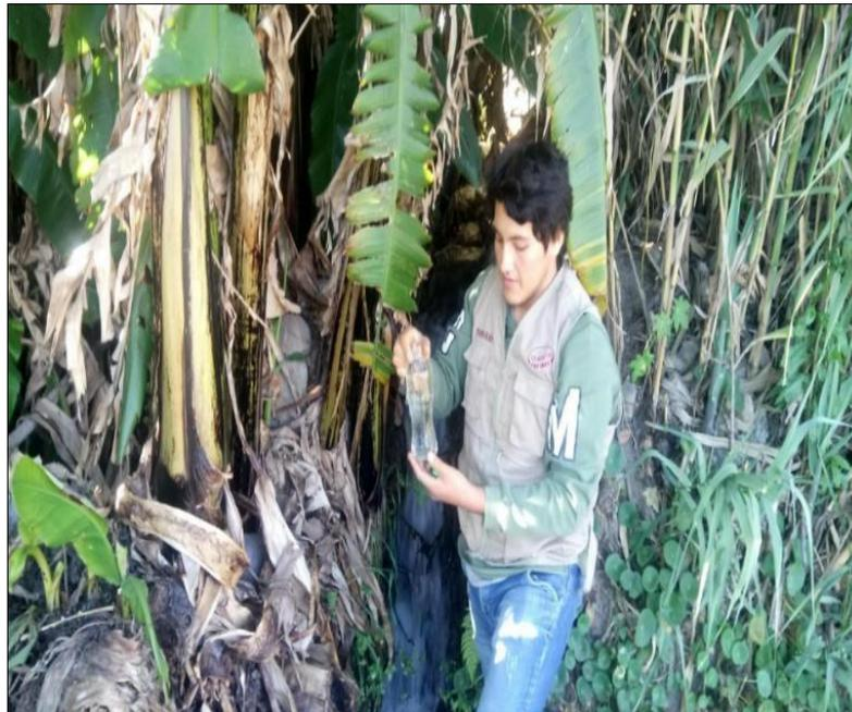
**Grafico 34:**Toma de muestra de agua para el análisis Fisicoquímico del agua
