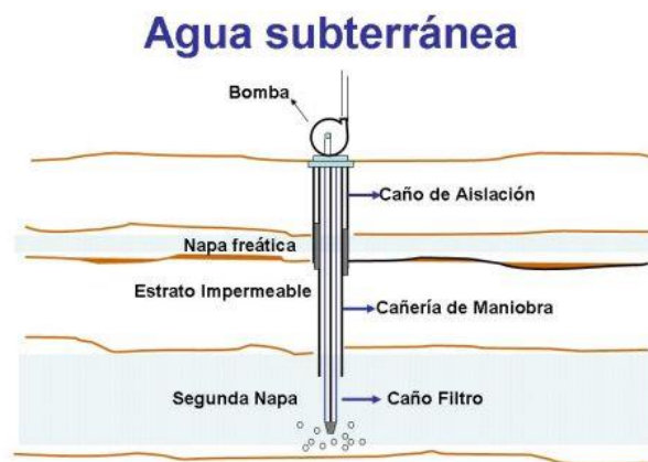
Figura 4. captación de agua subterránea
