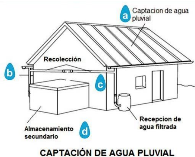
Figura 2. captación de agua pluvial
