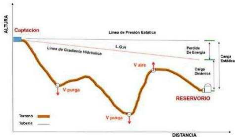
Ilustración N° 03.31. Línea de Conducción
