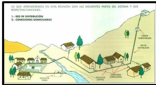
Imagen 10: Agua potable por gravedad
