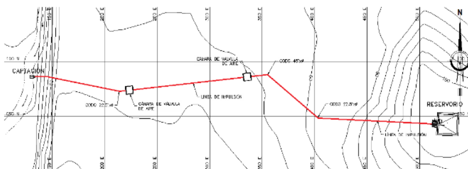
Ilustración N° 03.51. Línea de Impulsión
