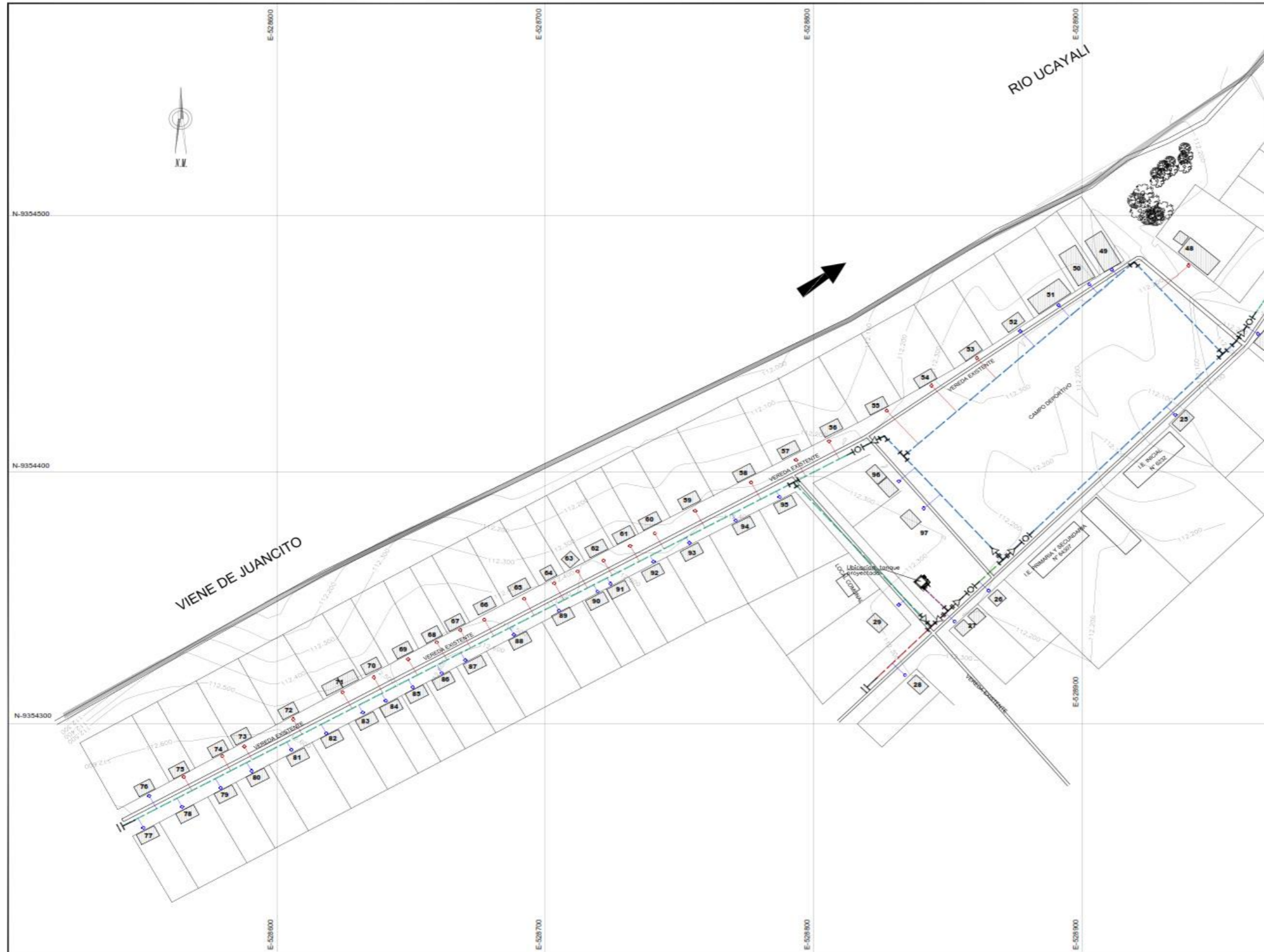
PLANO DE RED DE DISTRIBUCION DE AGUA POTABLE ESCALA: 1:750
