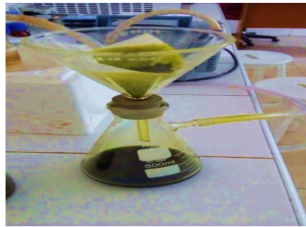
Filtración con papel de filtro mediante un equipo de bomba al vacío.
