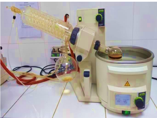
Se llevó al equipo rota vapor a 40° por 2 hr para concentrar el extracto separando todo el contenido de alcohol.
