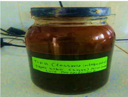
Maceración con 100g de hoja seca y molida y 500ml de alcohol de 80° por 8 días.
