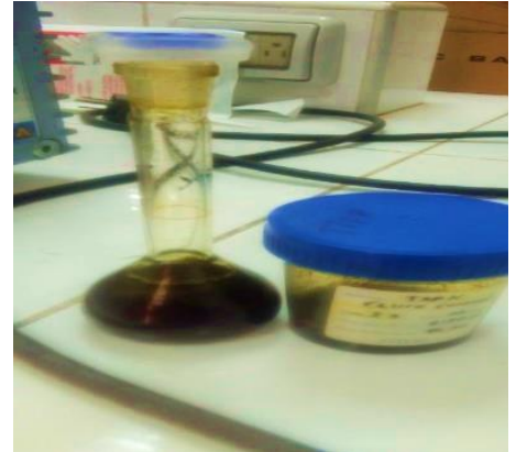
Proceso final del envasado del extracto hidroalcohólico en un frasco rotulado, luego transvasado y aforado con agua destilada en una fiola de 50 ml al 5% almacenado en refrigeración entre 4 y 8°C para su utilización.
