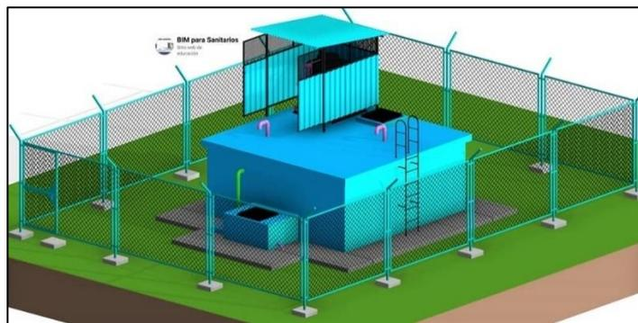
**Figura 9** Reservorio apoyado rectangular
