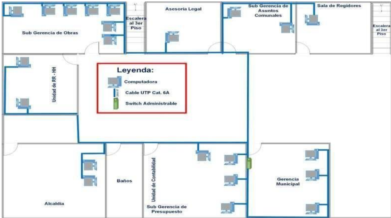
Gráfico Nro.17: Diseño físico propuesto de red para la municipalidad distrital de Corrales segundo nivel
