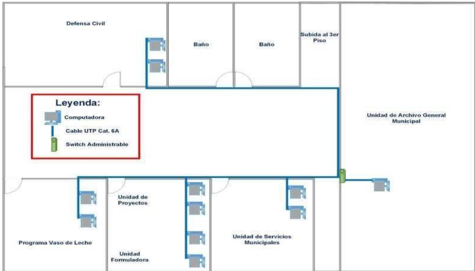
Gráfico Nro.18: Diseño físico propuesto de red para la municipalidad distrital de Corrales tercer nivel
