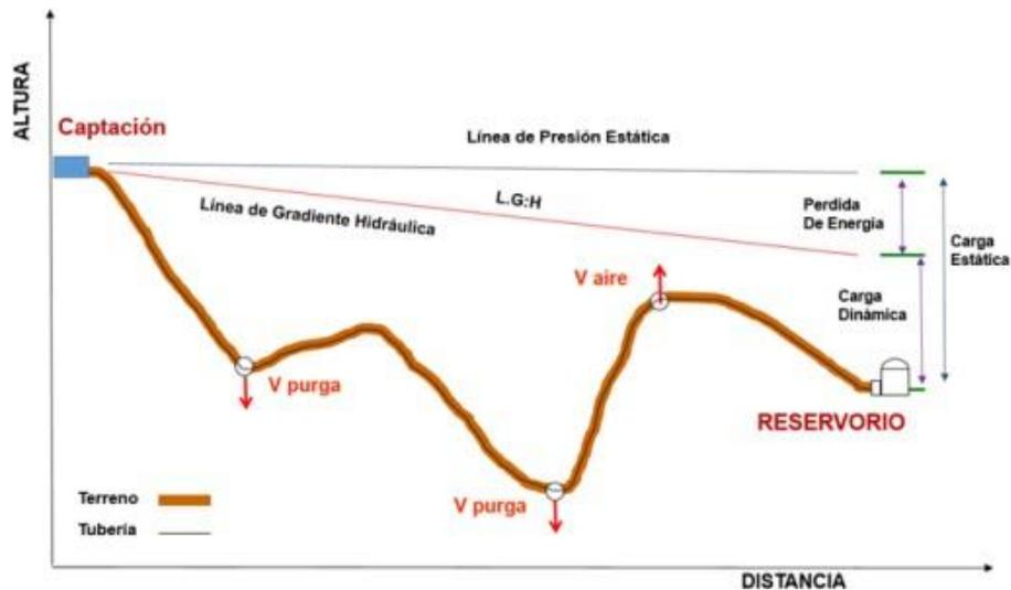
**Figura 2.** Línea de conducción (Ilustración 03.31. según norma técnica)
