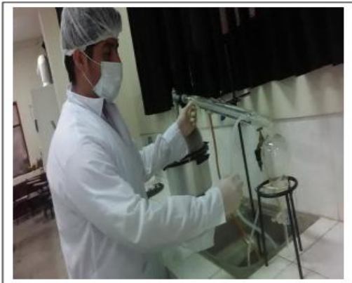
Figura N° 5: Preparación del equipo Destilación por arrastre de vapor de aceite esencial hojas y tallos de peperomia inaequalifolia “congona”
