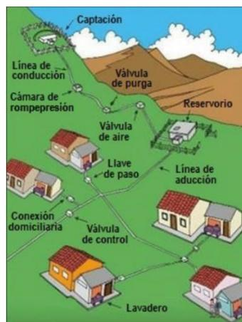
**Figura 1** Sistema de abastecimiento de agua potable
