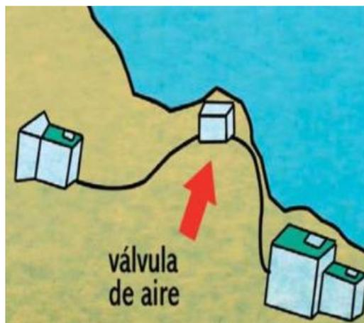
**Figura 8** Válvula de aire
