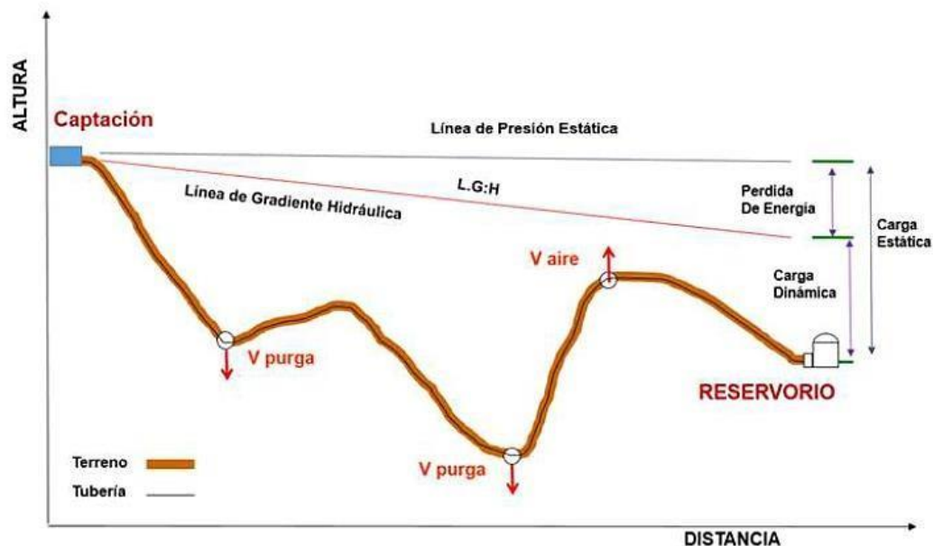
Ilustración N° 03.31. Línea de Conducción
