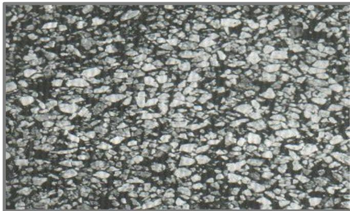
**Imagen 12. Pulimento de agregados**
