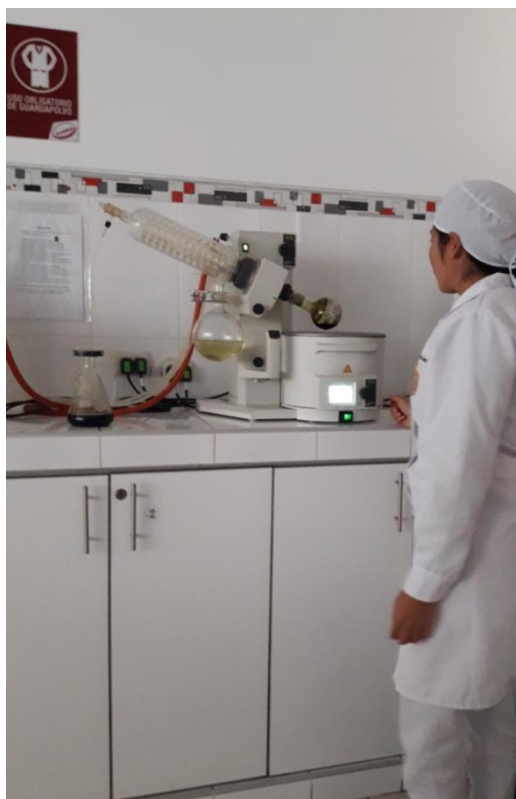
Fig.9. Volatilización del metanol a 45° de temperatura en 40 minutos por cada muestra.
