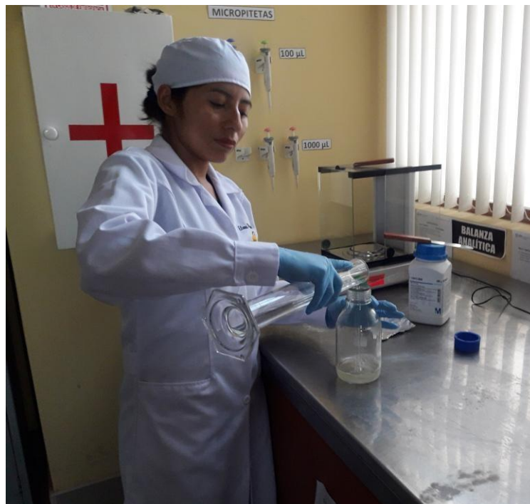
Fig. 14. Mezclamos 200 ml de agua destilada en el frasco donde se agregó 10 gramos de Agar Mueller – Hinton
