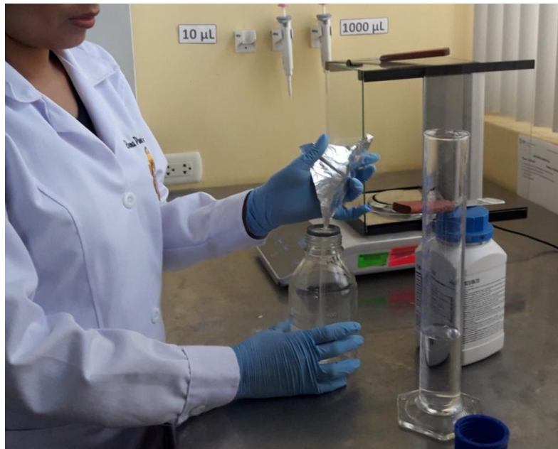
Fig. 13. Agregamos 10gramos de Agar Mueller –Hinton al frasco
