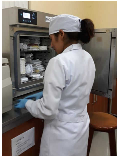
Fig. 26. Se lleva todas las placas Petri a la Incubadora a 27c° por 3 días.
