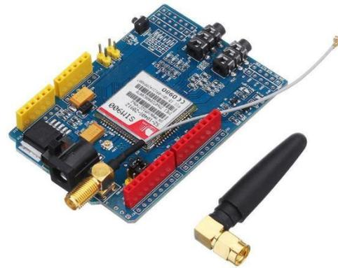
*Nota.* La imagen muestra un módulo GSM SIM 900 que habilita comunicaciones inalámbricas que transmite datos en redes de celulares en tiempo real. Tomada de (Ruiz y Domínguez, 2018).
