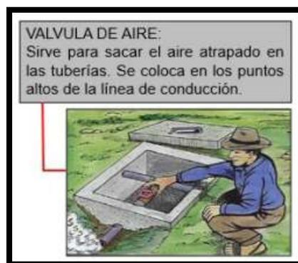
**Figura 10:** Válvula de aire
