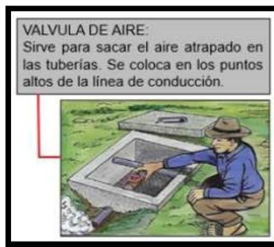
**Figura 5:** Válvula de aire
