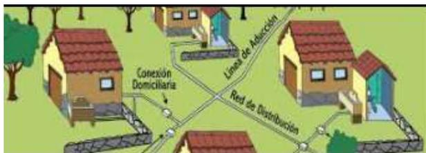
**Figura 8:** Línea de conexión, **aducción** y red de distribución
