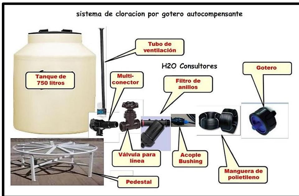
Figura 39: Elementos básicos de un sistema de cloración por goteo auto compensante Fuente: Slideplayer.
