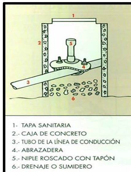
Figura 13: Caja de válvula de aire
