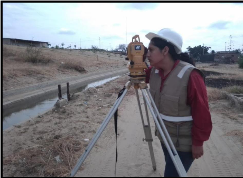
**Figura 10:** Levantamiento topográfico
