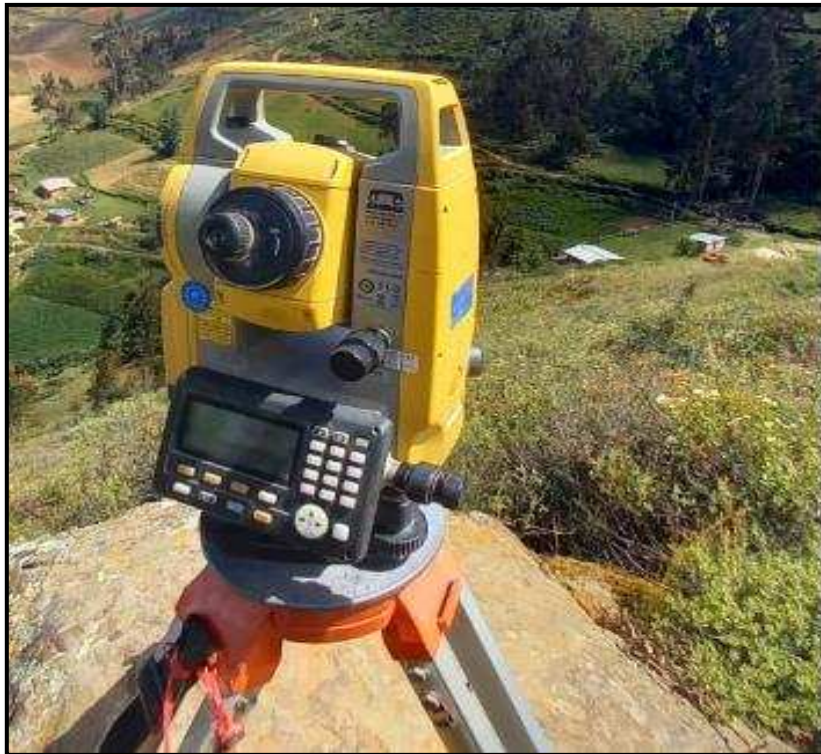
Figura 5: Levantamiento Topográfico para Sistema de Agua Potable.
