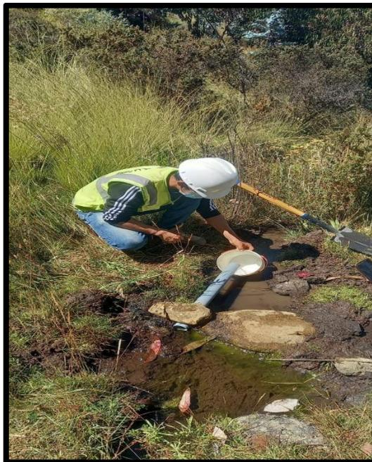
Figura 02: Realizando el afloramiento de la fuente para calcular su caudal del caserío de Huamishmalca.
