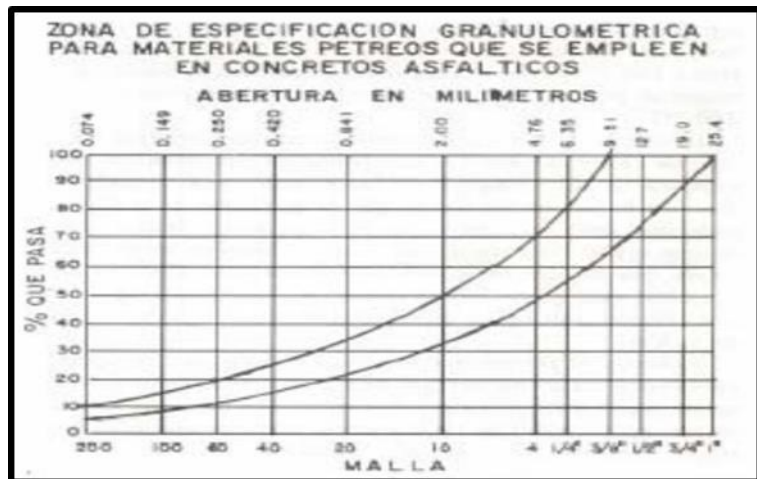
Figura_ 10 Zona En La Que Tiene Que Permanecer El Concreto Asfaltico.
