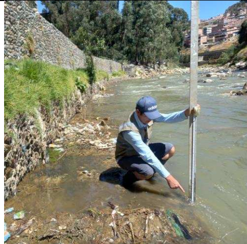
Foto N° 14: Nivel de agua, medición de la deflexión y socavación en el tramo 7.
