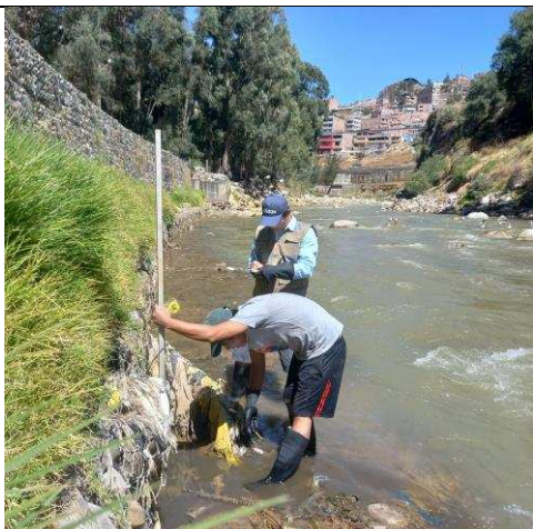
Foto N° 11: Nivel de agua, medición de la deflexión y socavación en el tramo 6.
