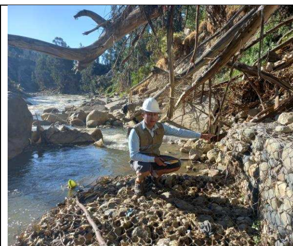
Foto N° 29: Nivel de agua, medición de la deflexión y socavación en el tramo 12.
