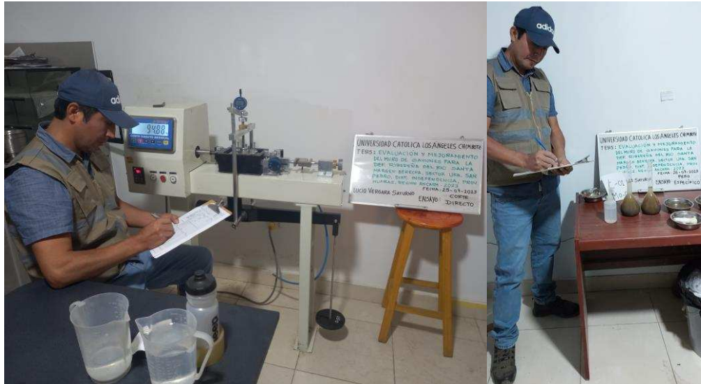
Figura IV.6: Labor. de suelos, corte directo (izq.) y peso específico (der.).
