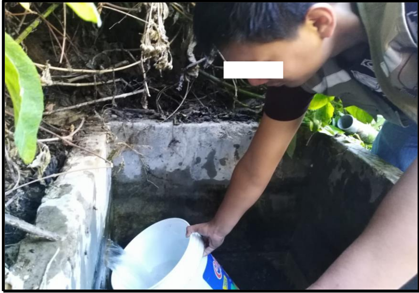
Fotografía 7 Medición de Caudal (Método Volumétrico)
