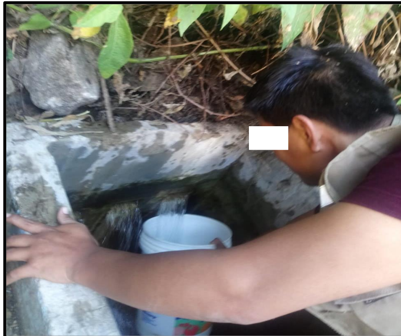
Fotografía 6 Medición de Caudal (Método Volumétrico)
