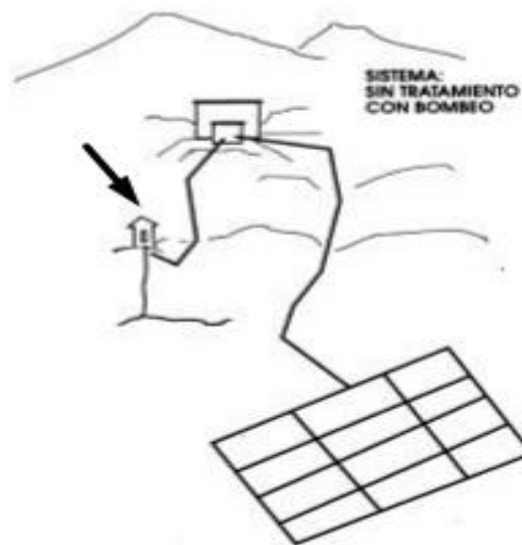
Figura 8. Conducción por bombeo
