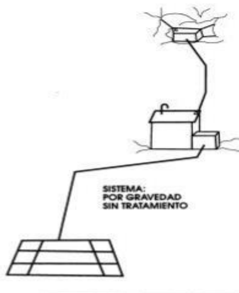
Figura 7. Conducción por gravedad
