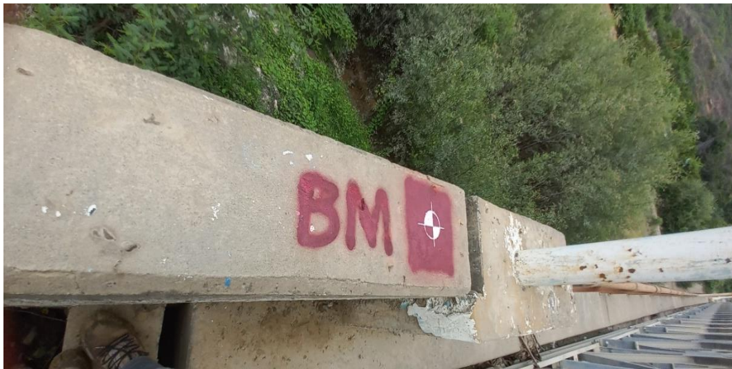
Figura 05 BM utilizado en la topografía
