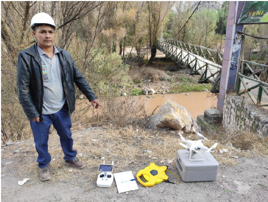
Figura 5.6: Instrumentos utilizados para el levantamiento Fotogramétrico.
