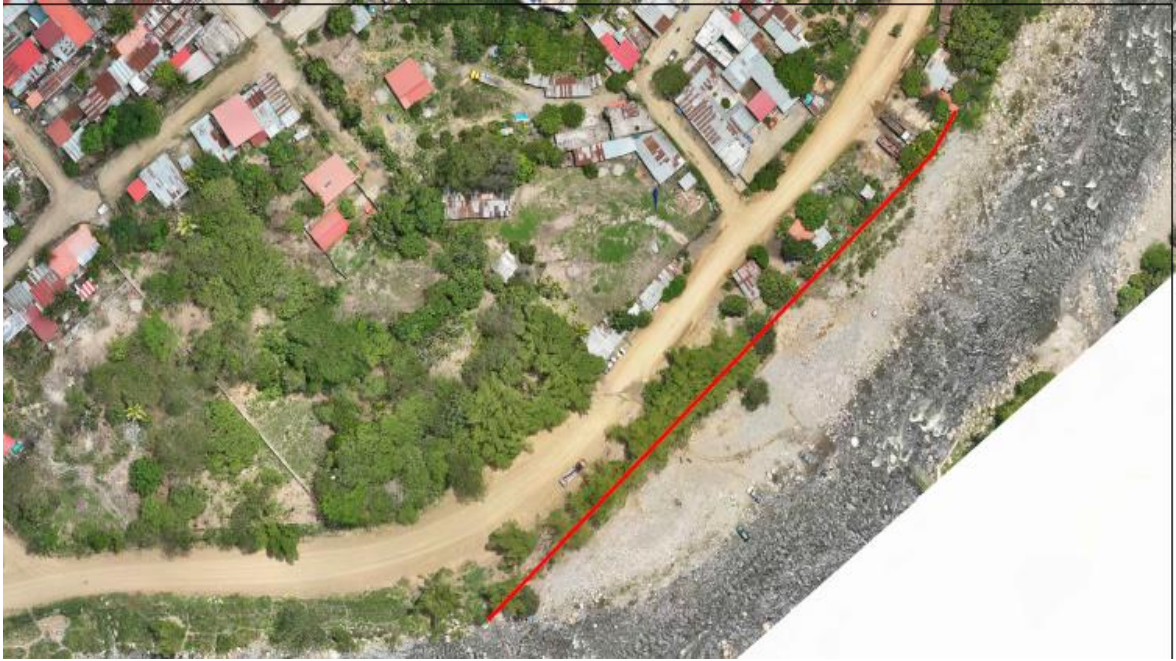
Figura 24: Mapa aéreo de la longitud del muro de gavión progresiva 1+444 a 1+644
