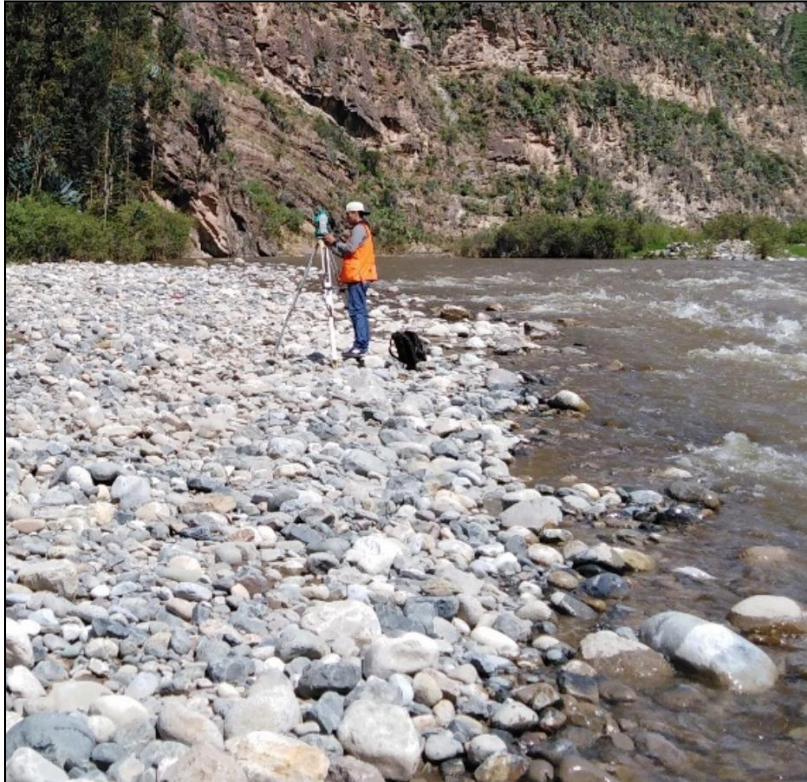
FOTOGRAFIA 1 – 2: VISTA DONDE SE APRECIA LEVANTAMIENTO FOTOGRAFICO Y TOPOGRAFICO (USO DE DRON AUTEL EVO 2.0 PRO, ESTACION TOTAL SOUTH N6 PARA PUNTOS DE CONTROL)
