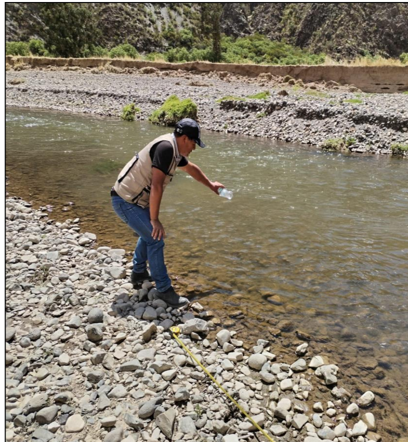
FOTOGRAFIA 3 – 4: AFORAMIENTO DE RÍO PARA CÁLCULO DE CAUDAL MÁXIMO POR MÉTODO DIRECTO (HUELLAS) CON FINES VALIDACIÓN DE DATOS DE ESTUDIO HIDROLÓGICO
