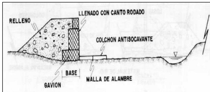
Figura 01: Esquema de muro de gaviones
