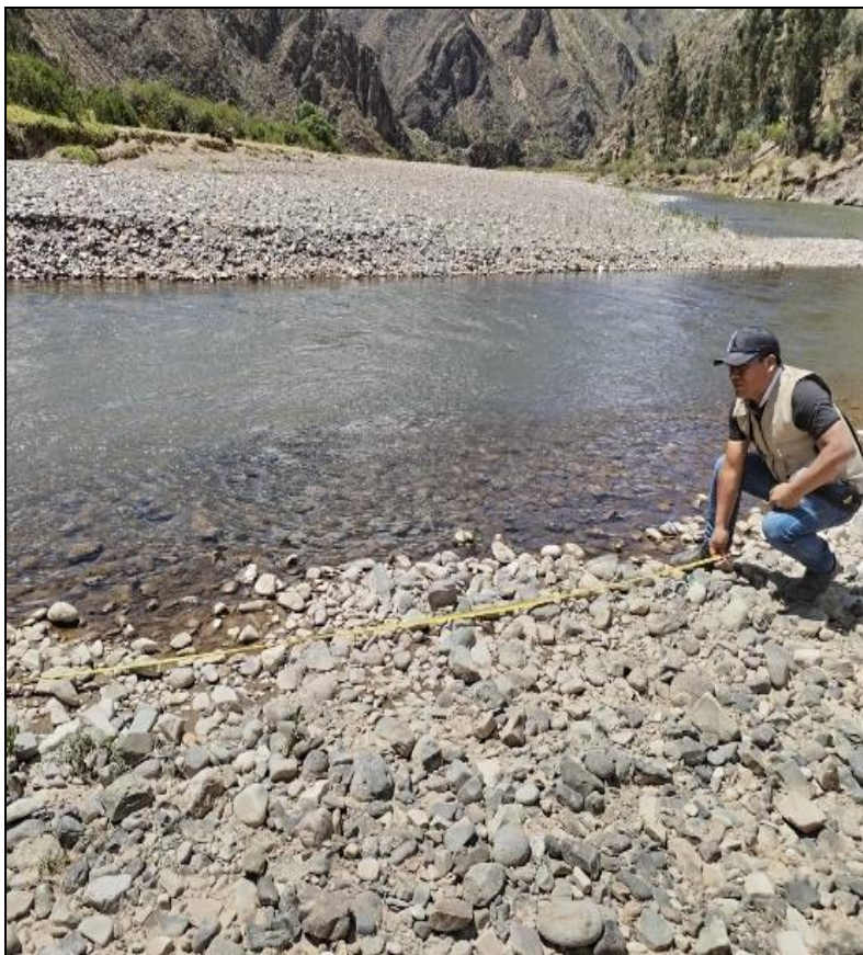
FOTOGRAFIA 3 – 4: AFORAMIENTO DE RÍO PARA CÁLCULO DE CAUDAL MÁXIMO POR MÉTODO DIRECTO (HUELLAS) CON FINES VALIDACIÓN DE DATOS DE ESTUDIO HIDROLÓGICO
