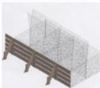
Figura 13. Encofrado posicionado junto a los gaviones. Fuente: (ACEROS METALES Y MALLAS LTDA, 2016)
