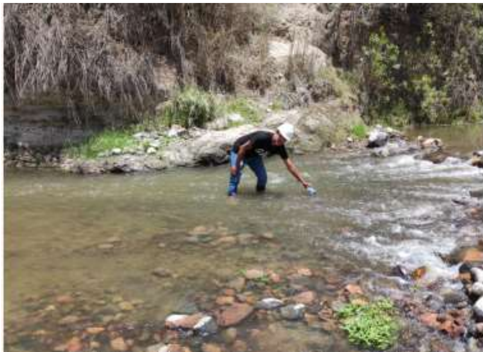
Figura 28: Método del Flotador para determinar la velocidad del Caudal del Río. Fuente: Elaboración Propia.
