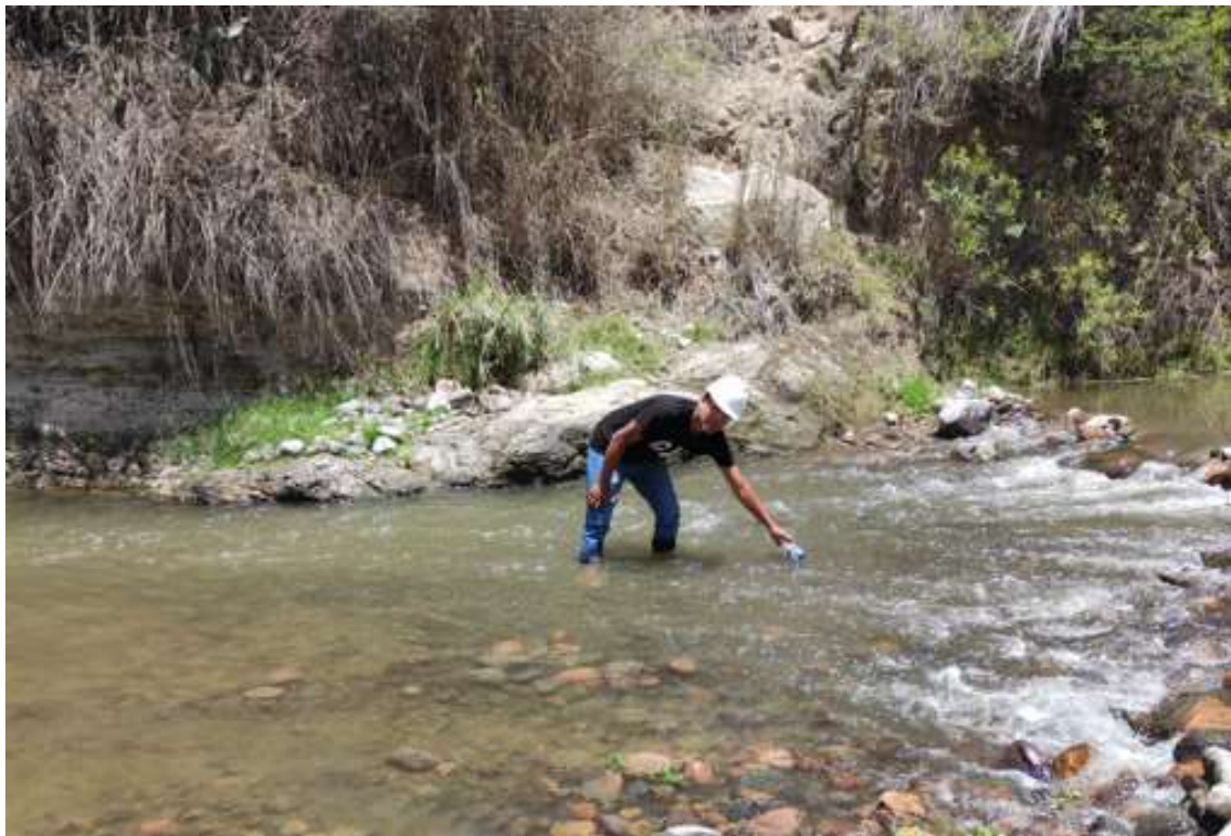
Figura 13: Medición de la Velocidad del Río por el método del Flotador. Fuente: Elaboración Propia.
