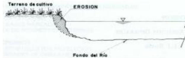
FIGURA N° 1. EROSION FLUVIAL - RIBEREÑA
