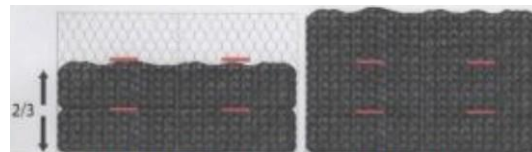
Figura 14. Posición de los tensores. Fuente: (ACEROS METALES Y MALLAS LTDA. 2016)
