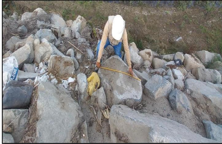
Figura 9. Medición del tamaño de rocas
