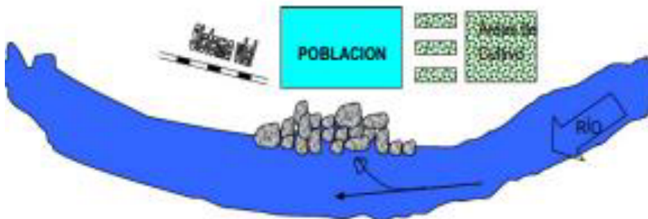
Grat. Nº 01: Dique de rocas al volteo
