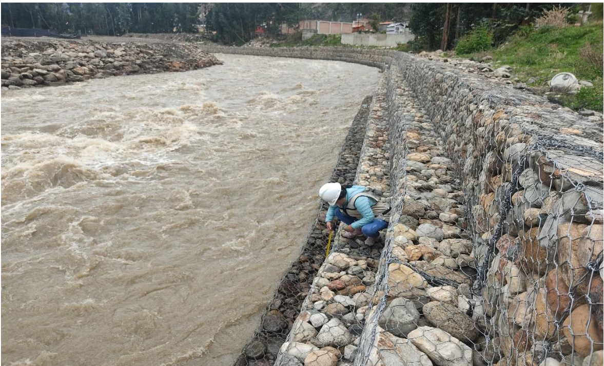
Ilustración 4: altura del gavión
